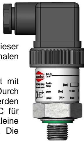
Der HDC arbeitet nach dem Prinzip eines Kolbendruckschalters und ist mit verschiedenen Abstufungen bis max. 320bar Einstellbereich konzipiert. Durch die besondere Bauweise des als Wechsler ausgelegten Schalters werden herausragende elektrische Leistungsdaten erreicht. Dadurch ist der HDC für Spannungen bis max. 250V mit einem Schaltstrom bis 4A und auch für kleine Ströme und Spannungen von 5V mit min. 5mA zuverlässig einsetzbar. Die Geräte werden mit Winkelsteckdose DIN EN 175301-803 geliefert.
